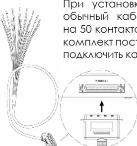
При установке порта telco требуется обычный кабель RJ21 Telco Apmhenol на 50 контактов и 25 пар (входит только в комплект поставки GXW4248). Вы можете подключить кабель к распределительной панели, что
